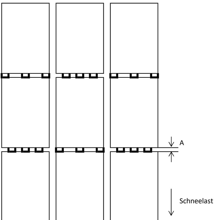
Die Anzahl Schneebremsen pro Modul ist abhängig von der Schneelast.
